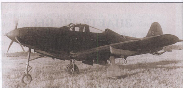
Испытания «Аэрокобры» на штопор. В хвостовой части на специальной балке закреплен противоштопорный парашют
