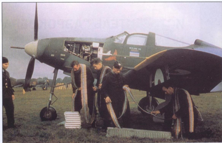
Подготовка вооружения на британской «Аэрокобре». Обратите внимание на ствол 20-мм пушки, выступающий из кока винта
