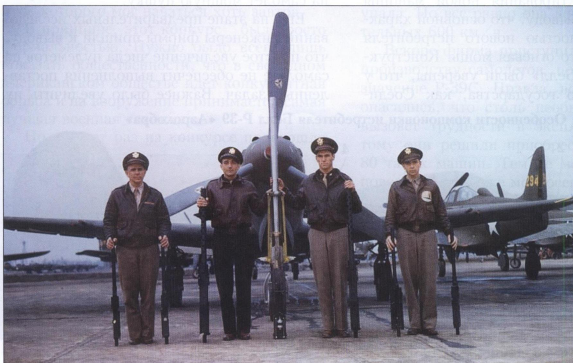
Механики демонстрируют вооружение «Аэрокобры»: в центре 37-мм пушка М4, по бокам от нее — пара крупнокалиберных 12,7-мм пулеметов и четыре пулемета обычного винтовочного калибра 7,62 мм
